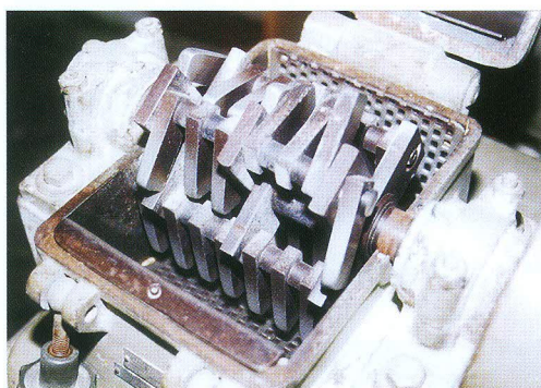
ลักษณะของแท่งเหล็ก ที่ตีไม้ให้แยกออกจากกัน
